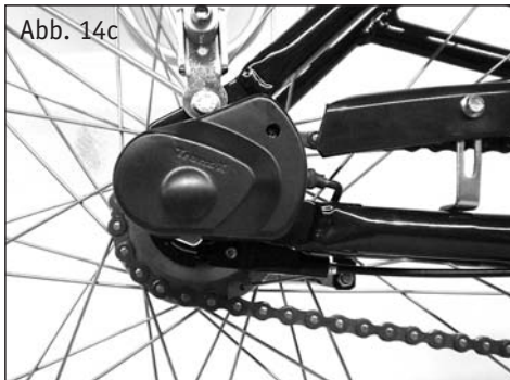
Hinterradsensor TMM 4 (hinter Schutzkappe) (TMM 4-Sensor mit abmontierter Schutzkappe)
