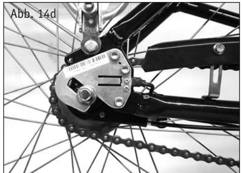
Hinterradsensor TMM 4 (hinter Schutzkappe) (TMM 4-Sensor mit abmontierter Schutzkappe)
